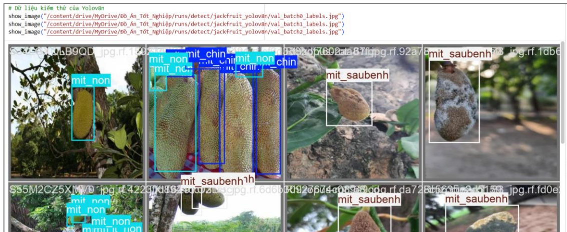
Hình 1.22. Hình ảnh kết quả đầu ra mô hình YOLOv8 với ảnh nhận dạng trái mít
