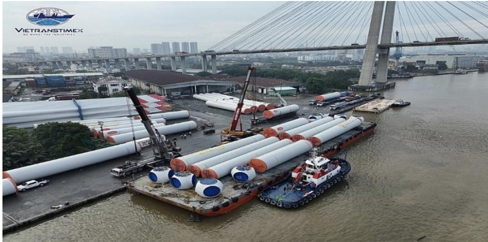
Hình 5. Vận chuyển bằng đường sông các trụ gió
