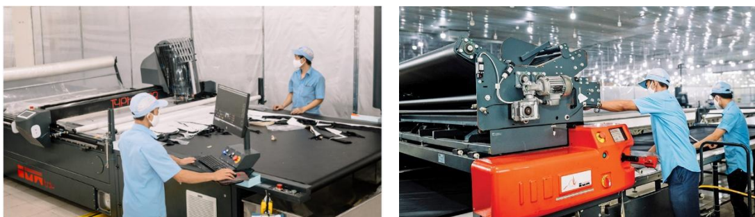
Hình 2.5. Hòa Thọ áp dụng công nghệ cắt vải tự động
